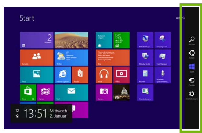
Abbildung 7: Die Charm-Bar (siehe rechter Bildschirmrand) stellt ein Menü dar, welches App-übergreifende Befehle umfasst. Es soll den Nutzer bei seinen wichtigsten Aufgaben am PC unterstützen und ist aus jedem beliebigen Programm aufrufbar.
